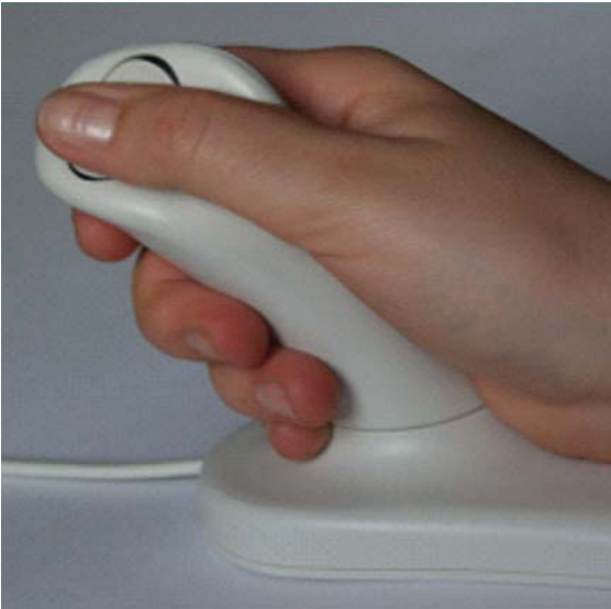
Obr. 8: Ergonomická myš, která umožňuje při práci vertikální polohu ruky, tlačítko pro kliknutí je umístěno pod palcem. ( http://www.itaac.com/ 7. 8. 2010)
