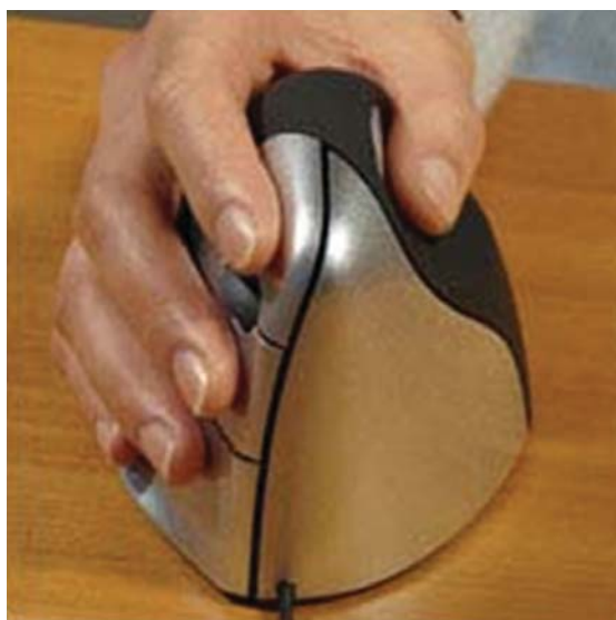
Obr. 7: Ergonomicky tvarovaná myš umožňuje udržovat při práci zápěstí ve fyziologické (střední) poloze a zabráňuje poškozování a bolesti zápěstí (Petit, o. s., http://www.petit-os.cz 7. 8. 2010).
